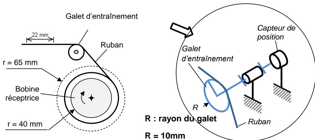
Le ruban, tracté par la bobine réceptrice, s'enroule autour d'un cylindre de rayon 40 mm. Lorsque la totalité du ruban est enroulée, le rayon de la bobine est de 65 mm.
