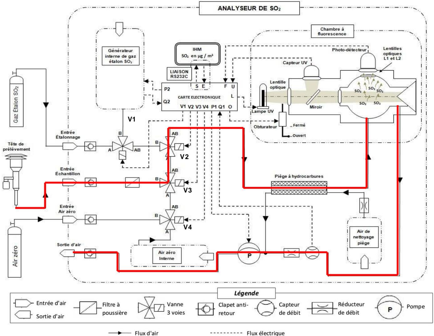
**Fonctionnement des vannes trois voies à commande électrique**
