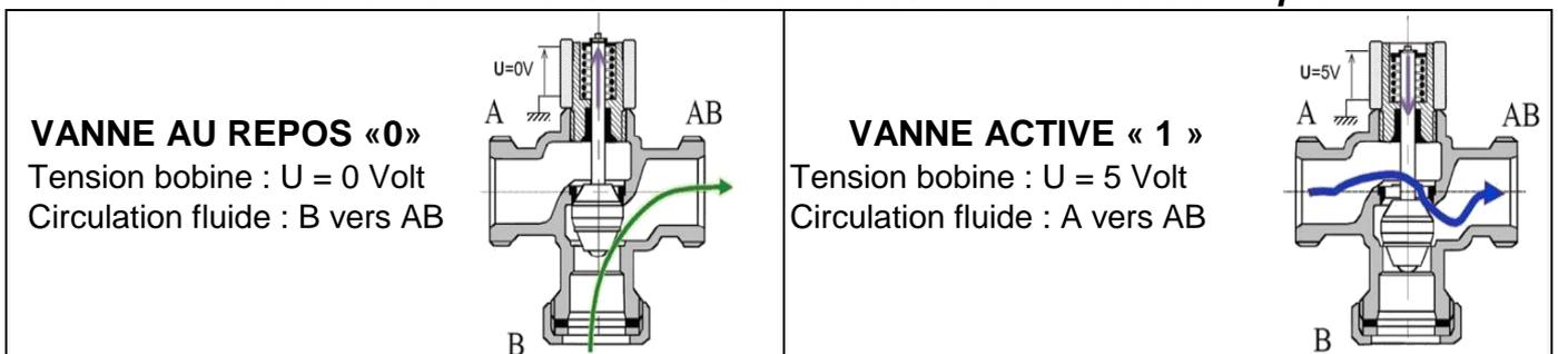
**États des vannes trois voies en mesure d'échantillon d'air (à compléter)**
