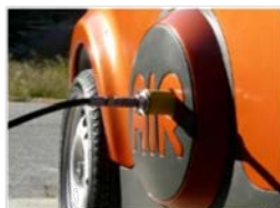
Recharge sur réseau d'air comprimé
