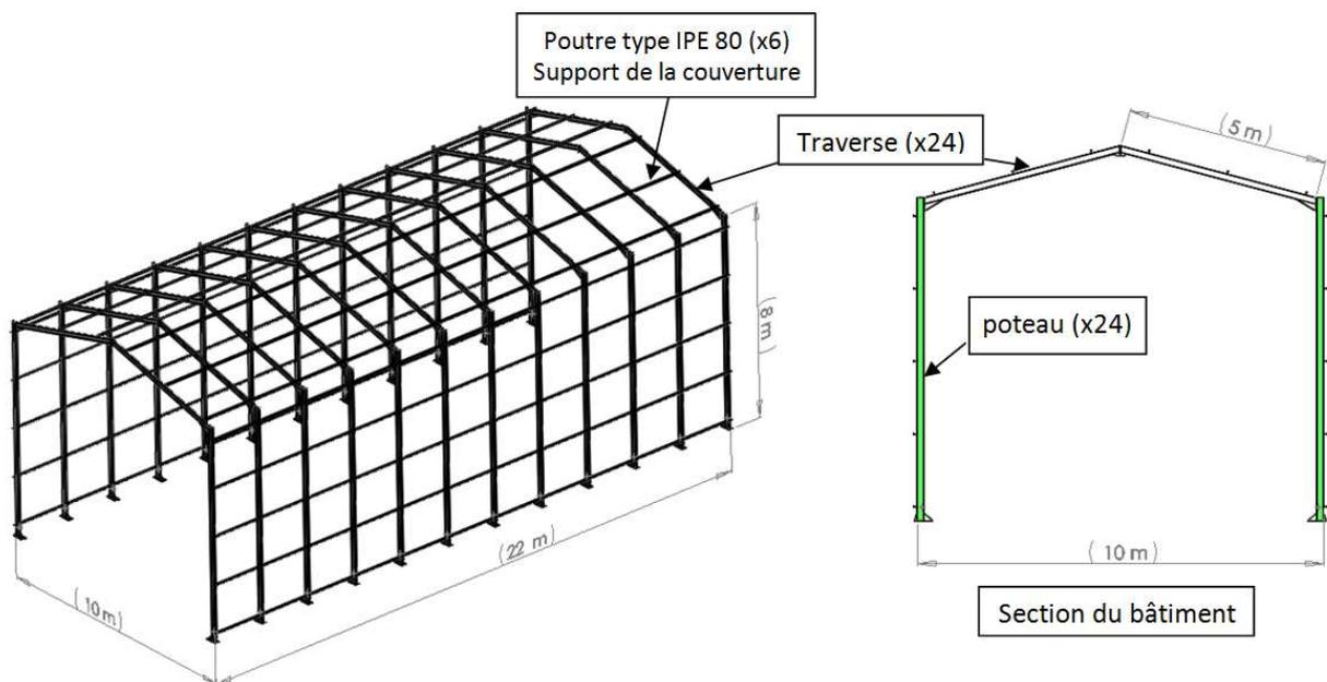
La structure du bâtiment est composée de 12 sections identiques espacées de 2 m.
