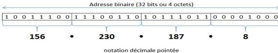
Une adresse IP d'un équipement, codée sur 4 octets, contient à la fois un identifiant réseau (NetID) et un identifiant équipement (HostID)
