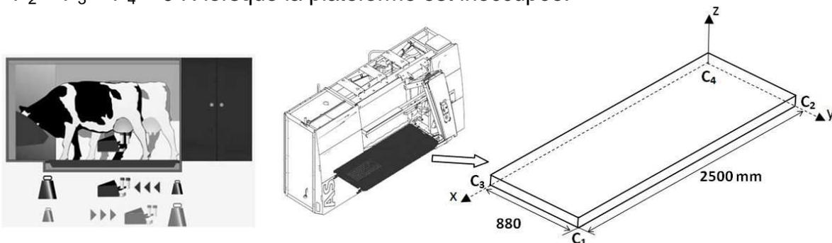
Lorsqu'une vache est présente, la plateforme est soumise aux efforts  $P_1$ ,  $P_2$ ,  $P_3$ , et  $P_4$  ainsi qu'au poids de la vache modélisé par une résultante de norme  $P$  appliquée au point  $G_v$ , centre de gravité de la vache.
