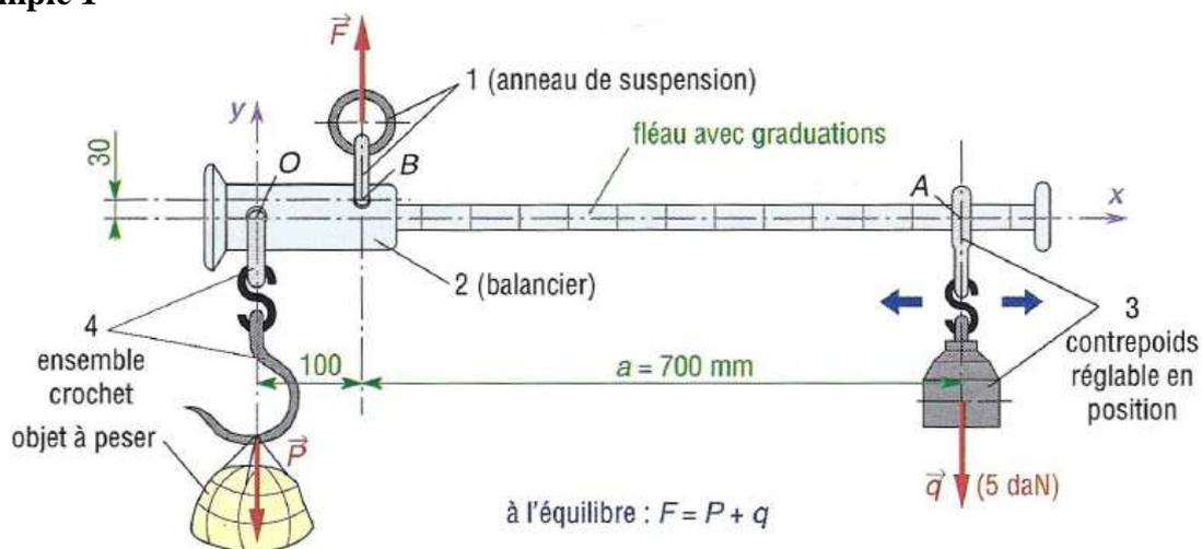
Une balance romaine se compose d'un balancier **2**, avec fléau gradué, articulé en **B** (pivot) sur un anneau de suspension **1** lié à un support fixe et d'un contrepois d'équilibrage **3** réglable le long du fléau (a variable) de poids **q** (5 daN). La masse à peser **P** est suspendue en **O** (pivot) par l'intermédiaire d'un crochet **4**.
